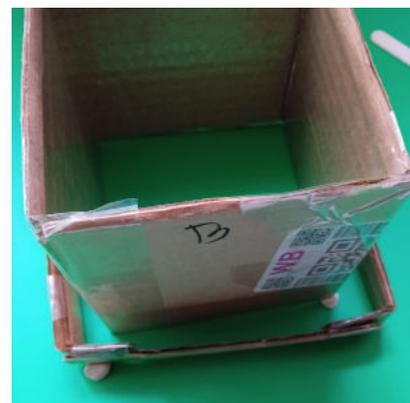
2. Обе опалубки были размещены на подложке (пластиковой разделочной доске) и в промежуток между ними сначала я накапал парафина с горящей свечи, чтобы он закрыл собой все мелкие просветы и щели между основной опалубкой и подложкой. Далее в промежуточную опалубку было залито дополнительное количество предварительно растопленного парафина.
