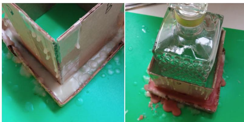
3. После застывания парафина изготовление молда было продолжено аналогично тому, как это делалось при создании литьевой формы для «свечи-текилы»\*. Следует признать, что когда залитая силиконовая масса набирала вязкость, обнаружилась её небольшая протечка, однако благодаря уже имеющейся густоте это не успело стать существенной проблемой. Ниже
