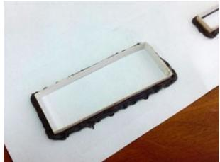
3. Теперь в полученную формочку можно залить подготовленную эпоксидную массу и оставить полимеризоваться.
