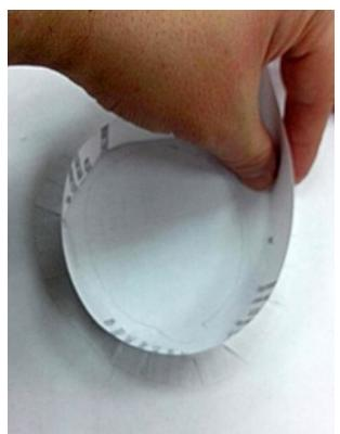
5. Проверяем, соответствие размеров опалубки и предмета-оригинала.
