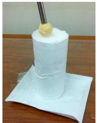
4. Удаляем бумагу, после чего сформованный цилиндр из ссохшейся соли при помощи ножа, напильника, надфilia или наждачной бумаги «обтёсываем» и придаём ему нужную форму.
