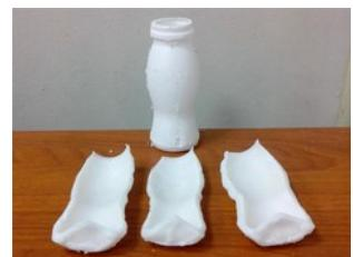
4. Полученные фрагменты из парафина складываем друг с другом и фиксируем канцелярскими резинками и/или скотчем.
