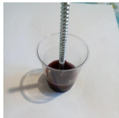
4. После застывания этой порции заготовка-болванка была готова (охлаждал её на улице и благодаря разнице в способности к тепловому расширению парафин сам отстал от стенок стаканчика и легко извлёкся).
