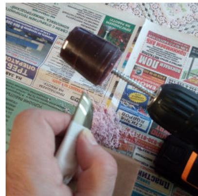
7. Для выравнивания поверхности я заготовку немного подшлифовал малярным скотчем, благо что свечной парафин – материал мягкий и податливый.
