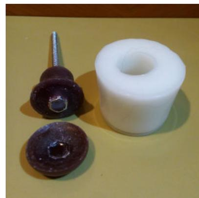
10. Молд был успешно испытан – с его помощью изготовлена пара дверных ручек заливкой «жидкого пластика».
