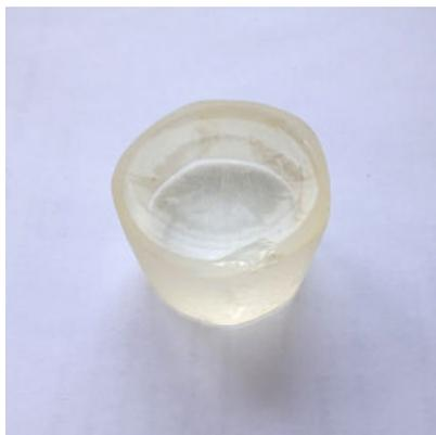
При эксплуатации изделий изменений также не избежать, весьма наглядно это демонстрируется на силиконе. Материал формочки, полученной когда-то при помощи пятирублёвой монеты\*, после ряда заливок в неё эпоксидной массы заметно пожелтел, стал терять прочность на разрыв и крошиться на краях (то же наблюдается и у других молдов из силикона «Полидел») – на следующем фото внизу справа для сравнения приведён «свежий» молд, изготовленный из юбилейной монеты:
