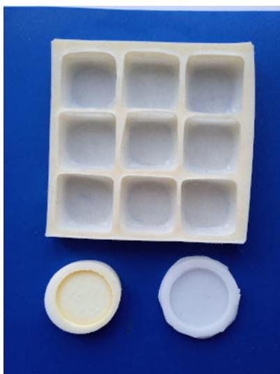
В верхней части снимка можно видеть молд для декоративной плитки из колерованного в массу гипса\*\*. Легко заметить, что этот материал по сравнению с эпоксидкой для силикона более щадящ, хотя многократные заливки приводят к образованию надрывов и микроцарапин, в которые забиваются частицы пигмента, а это сказывается на внешнем виде молда.
