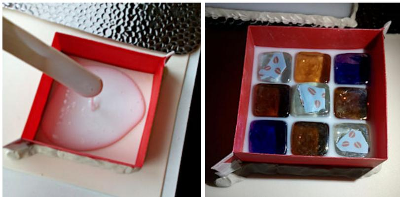
4. После застывания силикона, в форму залили подготовленную (содержащую наполнитель и краситель) эпоксидную массу. Когда и она затвердела, опалубку удалили, а следом сняли с заготовки силикон – он хорошо отделился и стащился одним куском.
