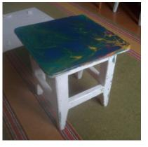
6. При помощи наждачной бумаги были выровнены боковые поверхности сиденья табуретки и удалены излишки эпоксидной массы.
