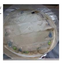
12. После заливки каждой новой порции эпоксидной массы выдерживалось время, необходимое для растекания и набора ей вязкости в процессе полимеризации. В общей сложности на заливку изделия такого размера потребовалось три упаковки (по 280 г) эпоксидного клея, причём в последнюю порцию эпоксидной массы добавлено совсем немного мела, чтобы вязкость была минимальной для лучшей растекаемости и выравнивания поверхности.
