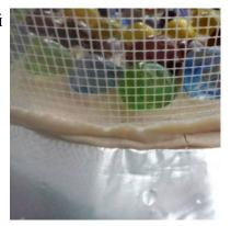
10. Далее была подготовлена масса для заливки. Для этого сначала в эпоксидную смолу вводился мел (он играл роль наполнителя для экономии самой смолы), пока она не стала густой и слабо текучей — мешать такую смесь становится довольно тяжело. После добавления туда же отвердителя и перемешивания полученная масса немного разжижается и приобретает вполне достаточную текучесть.
