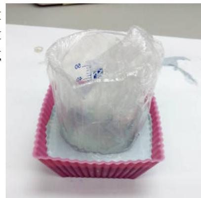
2. После затвердевания цементного раствора изделие извлекли из формы и вытащили из него стаканчик.
