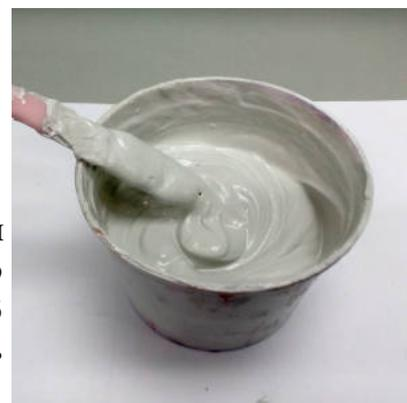
2. В затворённую смесь был добавлен колер для краски марки “Palizh” цвета «Ультрамарин» в количестве порядка одной столовой ложки.
