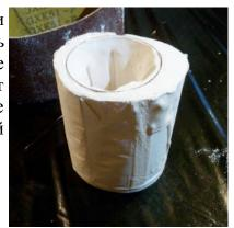
7. Теперь можно приступать к извлечению сосуда-оригинала. При помощи лезвия для ножовки по металлу сделайте три вертикальных пропила в гипсовой заготовке, примерно на равном расстоянии друг от друга. Пропиливать до поверхности оригинала не требуется, желательно в каждом пропиле сохранять места, где остаточная толщина гипса будет около 5 мм. Если сосуд-оригинал прозрачный, то глубину пропила довольно легко контролировать рассматривая внутреннюю часть заготовку на просвет.
