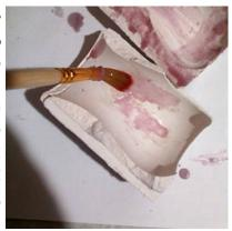
Обработка парафином вполне позволяет заполнить небольшие каверны, возникшие при заливке из-за пузырьков воздуха в гипсовом растворе, а также «склеить» расколы частей формы (слепка).
