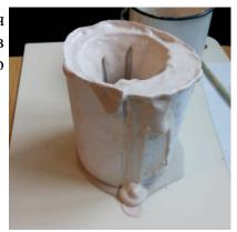
6. Через несколько дней, когда гипсовая заготовка схватится и высохнет, отделите её от подложки, также можно ободрать бумажную опалубку (при этом слой бумаги, при заливке непосредственно контактировавший с гипсовой смесью, прилипнет достаточно прочно — стараться его отрывать необязательно). Также можно выровнять верхнюю часть слепка при помощи наждачной бумаги.
