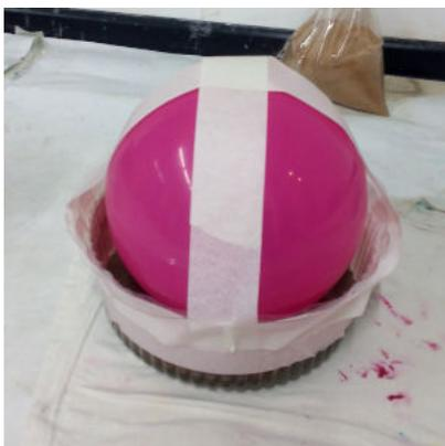
3. После заполнения формы остальной частью раствора пришлось дополнительно закрепить шарик, так как его весьма сильно выталкивало из цемента.
