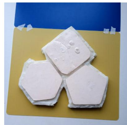
2. Внешнюю сторону силиконовой опалубки оклеили малярным скотчем, а затем из подручных материалов (пластелин, деревянные шпатели, обрезки алюминиевого и пластикового уголков, а также прозрачная прямоугольная полимерная крышка от коробки) соорудили ещё одну опалубку.
